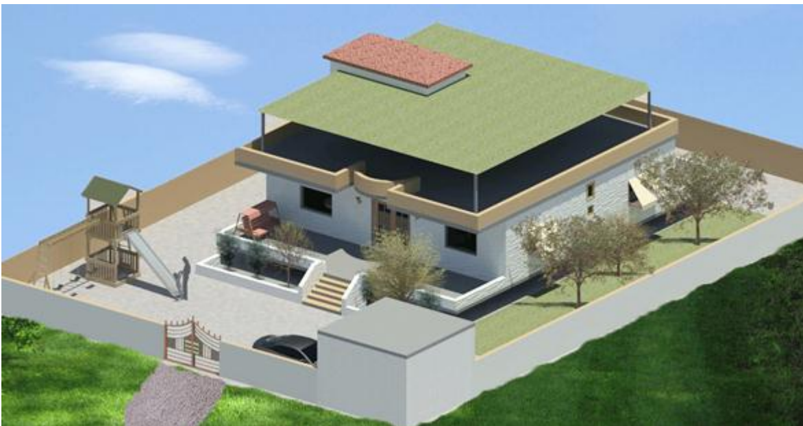
Figur 7.5 Optimal utformning för huset under sommarhalvåret med solavskärmning av taket med pergola.
